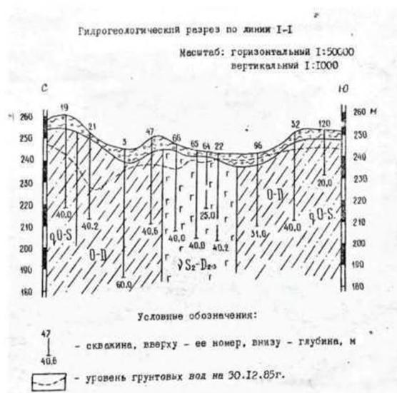
Рисунок 1 - Гидрогеологический разрез [8, с. 46]
